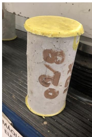
Figura 1 – Corpo de Prova Capeado
